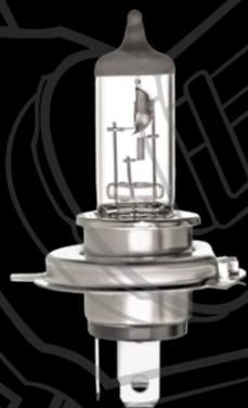
от батареи. Галогенный газ, используется в галогенных лампах для того, чтобы замедлить испарение вольфрама посредством перераспределения его на нити накаливания. Это позволяет повысить срок службы лампы и улучшить интенсивность освещения (с более высокой температурой внутри цоколя). Вольфрамовая нить накаливания имеет форму спирали, за счет чего она имеет большую длину, и соответственно, производит больше света.
